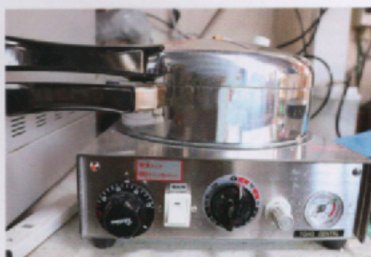
図 17 現在 K3W スプリントの製作に用いている重合器（プレッシャーポット、東邦歯科産業）。低温長時間重合により、義歯修理、矯正装置などの重合・加圧・埋没が正確に行える。
